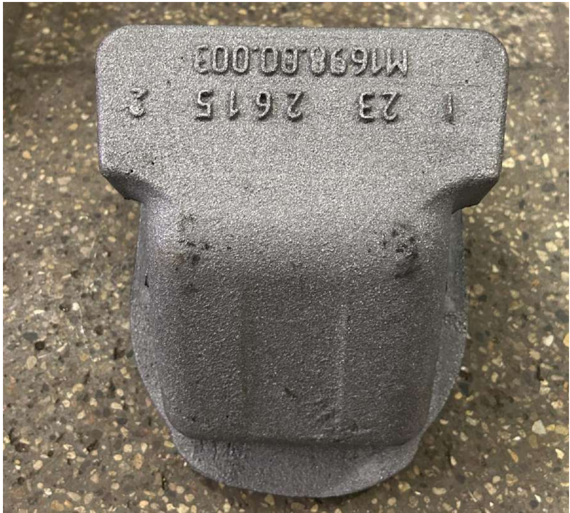
Рисунок 1 Внешний вид фрикционного клина, изготовленного по чертежу ПКБ ЦВ № М 1698.00.003 «Клин фрикционный»
